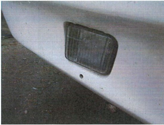
DSCF7062 Popękany reflektor przeciwmglowy
